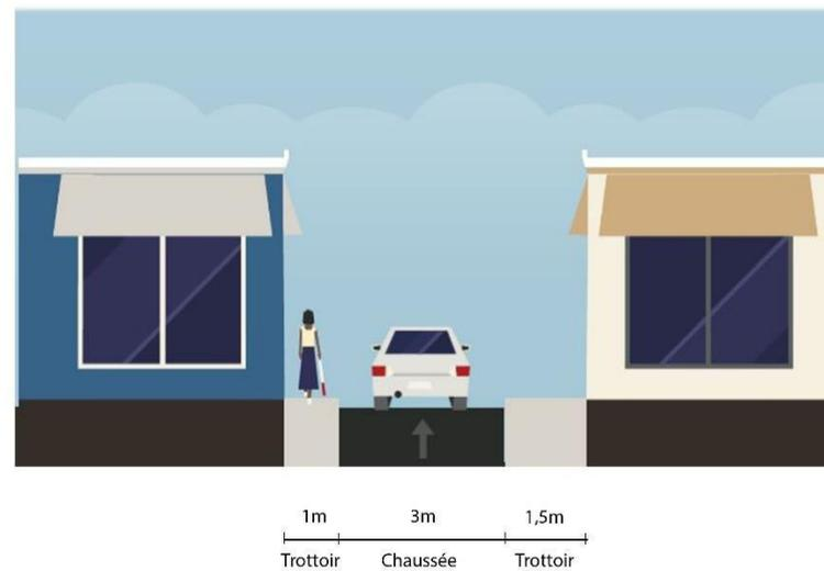
Figure 30 : Profil en travers schématique 3 - Rue Despointes
